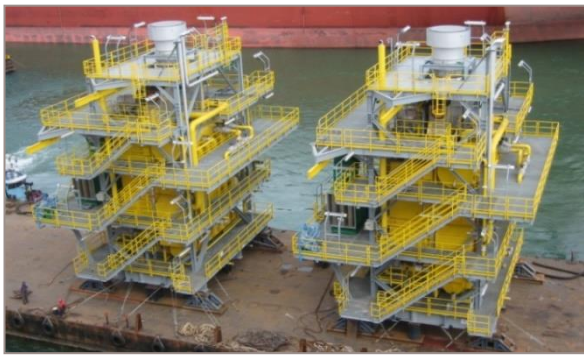
Aalborg boiler modules for Cidade de Sao Mateus
